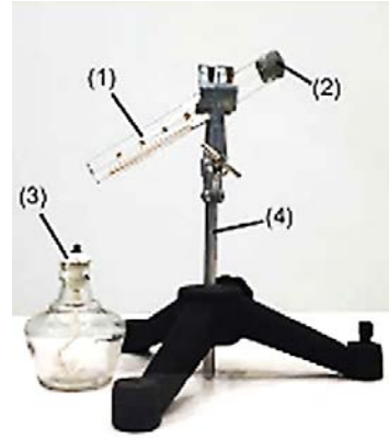
Hình 2.2. Thí nghiệm về mối liên hệ giữa nội năng của vật với năng lượng của các phân tử khí
